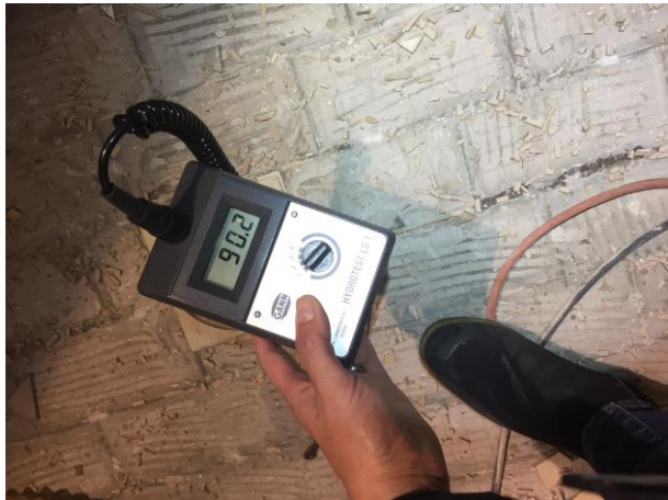
Seinien laatoitukset irtoavat alustasta koska tasoite ei ole tarttunut kahitiileen. Saunan lattiakaivon ympärillä on kohonnutta kosteutta.
